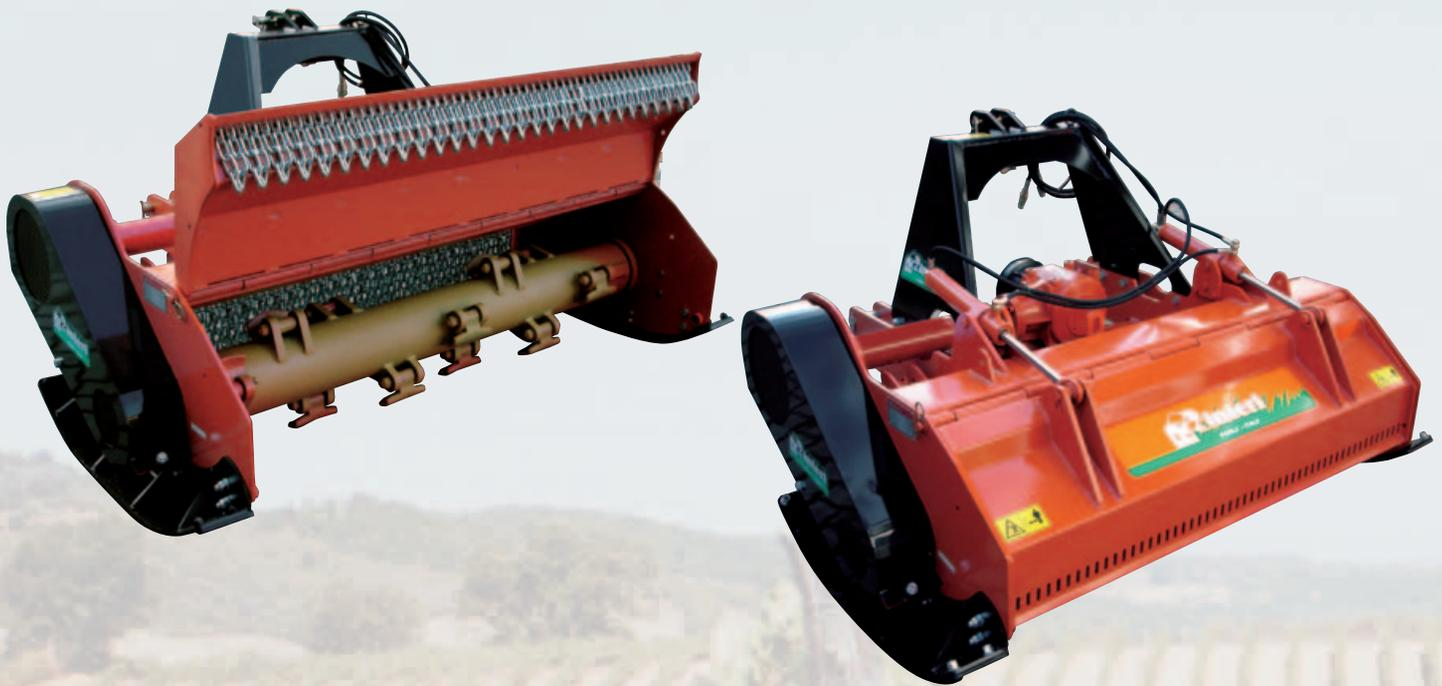
Trinciatutto tipo forestale molto robusto per la pulizia del sottobosco in grado di tritare rami con un diametro di 15 cm. E' dotato di un rotore di grande diametro con mazze del peso di Kg. 1,8. Il cofano posteriore apribile idraulicamente e le slitte a mezzaluna permettono al TRK di lavorare in entrambi i sensi di marcia.
